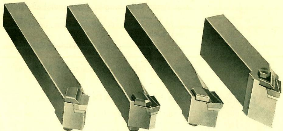
Denkbar einfache, gehärtete Stahlhalter mit Rapidstahluntersatz für das Schneidplättchen zum Schrapp-, Seiten- und Kopierdrehen, mit zweiseitig angeschliffenen Hartmetallplättchen für grösste Leistungen, die im Vergleich zu Wegwerfplättchen, 10-15 mal auf einfache Weise nachgeschliffen und für 80% aller anfallenden Arbeiten verwendet werden können.
